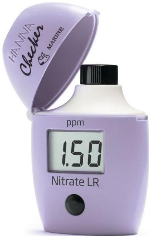
**-Rango: 0,00 a 5,00 ppm (como NO<sub>3</sub>-) [0,0 a 50,0 ppm (calculado) mediante dilución]**
