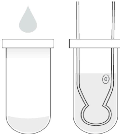
\* Nunca almacene electrodos de pH u ORP en agua destilada o desionizada. Si lo hace, acortará la vida útil del sensor.
