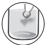
**¿Por qué?** – Limpiar el bulbo del electrodo de pH con toallas de papel producirá una carga estática que interferirá en las mediciones, adicionalmente con el tiempo puede taponar la membrana sensitiva, generando daños irreparables en su electrodo.
