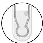
**¿Por qué?** – Almacenar el electrodo de pH en agua destilada o similares, producirá pérdida de iones de la solución electrolítica y membrana de vidrio, provocando que el electrodo de pH se dañe prematuramente.
