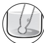
**¿Por qué?** – Tanto el bulbo de vidrio como la unión de referencia deben estar completamente sumergidos para tomar correctamente las mediciones.
