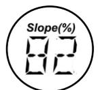
**¿Por qué?** – Los electrodos de pH son elementos consumibles. Con el tiempo el elemento sensitivo de pH se va desgastando y eventualmente fallará.
