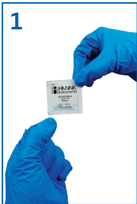
1 Tomar el sobre del reactivo por una punta y golpear suavemente la punta opuesta
