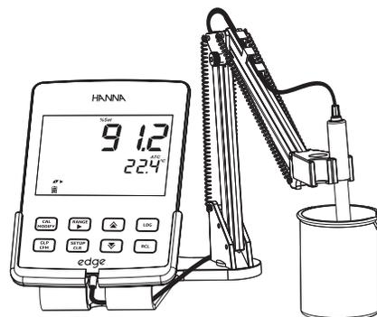
La duración del proceso de polarización varía desde unos minutos a varias horas, dependiendo de los instrumentos, y es uno de los factores que diferencian este tipo de instrumentos. Los medidores de oxígeno de HANNA Instruments completan el proceso de polarización en aproximadamente 6 minutos, lo que los sitúa entre los más rápidos de la industria.
